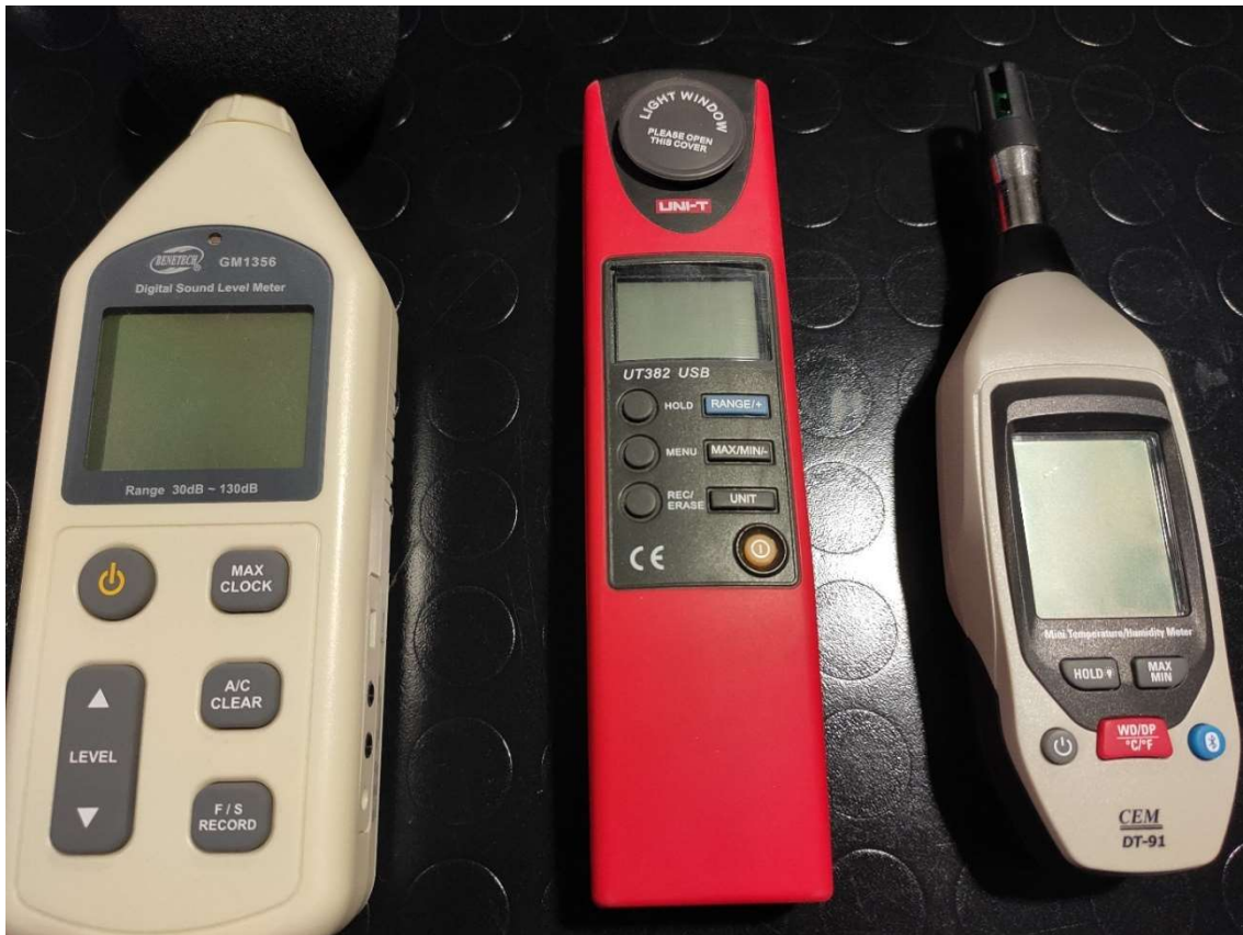
Rys. 2.5. Wykorzystywane mierniki do pomiarów warunków ergonomicznych w pomieszczeniu.
